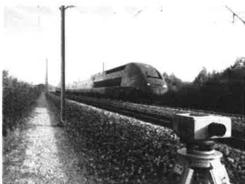
Exemple d'utilisation du niveau électronique dans le cadre du suivi altimétriques des ouvrages SNCF
